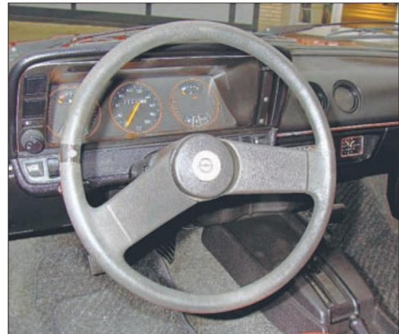
Nur das Nötigste: Die Quarzuhr (rechts) und das Radio (verdeckt) sind die einzigen elektronischen Bauteile im alten Ascona-Cockpit.
